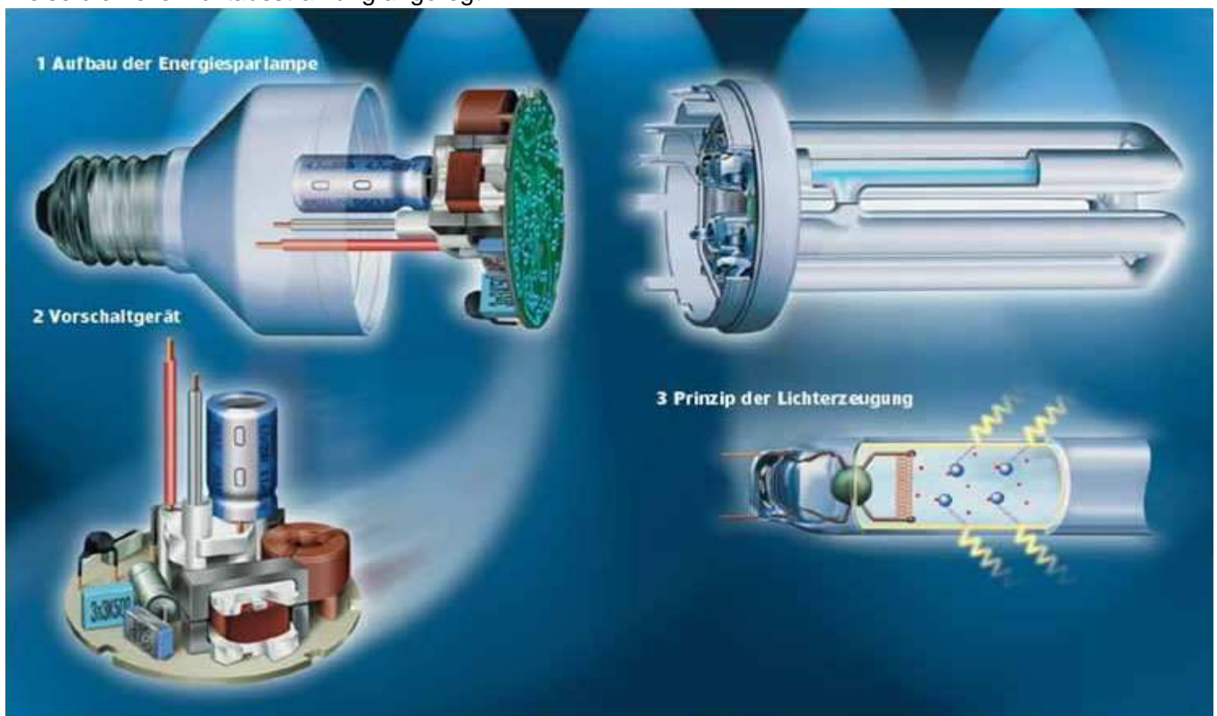
Teile einer Energiesparlampe
