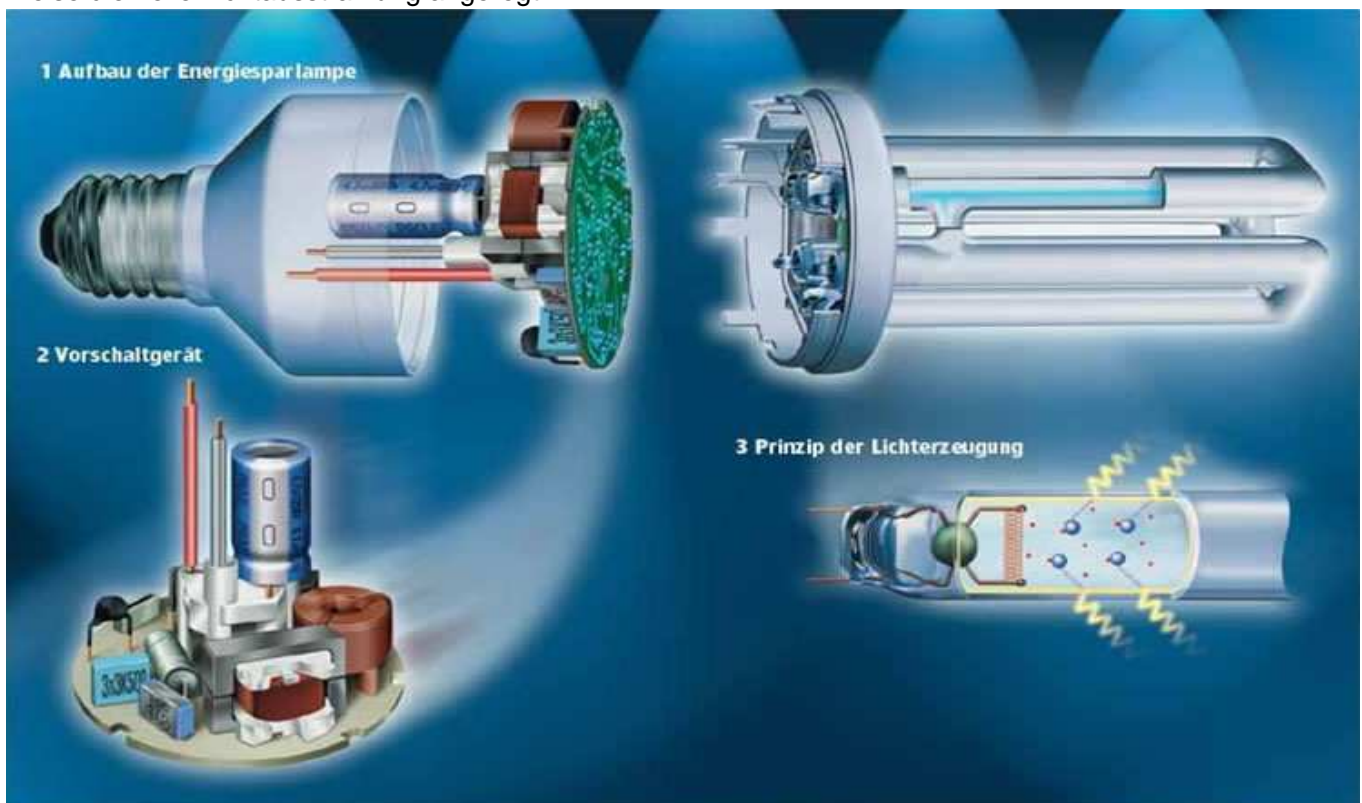
Teile einer Energiesparlampe
